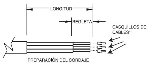
\*Furman recomienda el uso de casquillos de cables (no se incluyen) para que los cables trenzados terminen en conectores de acoplamiento.
