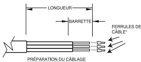
\*Furman recommande l'utilisation de ferrules pour câbles (non comprises) pour raccorder le câble tressé dans le connecteur d'accouplement.
