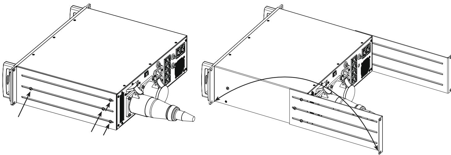
Simplemente quite los tornillos de seguridad de las porciones frontal y lateral de la muesca del estante posterior ajustable y la placa lateral de refuerzo (ubicados en cualquiera de los laterales del chasis). Inviértalos y vuelva a adjuntarlos al chasis del P-6900 AR E. (como se muestra a la derecha).
