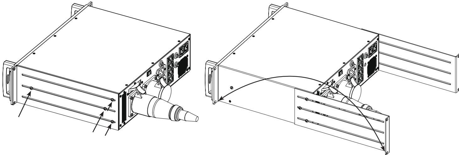
Retirez simplement les vis de montage des parties avant et latérales du bâti réglable à l'arrière du P-6900 AR E et la plaque latérale de renfort (située d'un côté ou de l'autre du châssis). Inversez-la et réassembliez-la sur le châssis du P-6900 AR E (comme montré sur la droite).
