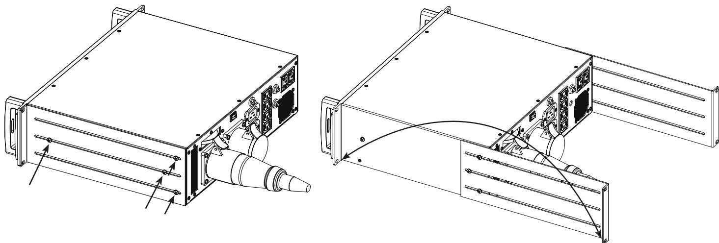
Lösen Sie einfach die Sicherungsschrauben an den Seiten und an der Vorderseite des hinteren Rack-Ear und der Verstärkungsplatte an beiden Gehäuseseiten des P-6900 AR E. Drehen Sie diese um und befestigen Sie diese am Gehäuse des P-6900 AR E (zoals hier getoond).
