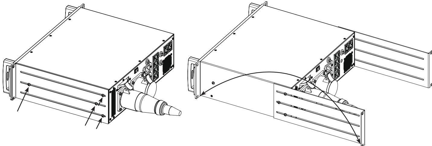
Для этого открутите крепежные винты на боковой и передней части регулируемых боковых накладок жесткости с проушиной крепления к стойке (расположенных на обеих сторонах корпуса стабилизатора P-6900 AR E). переверните эти накладки и вновь прикрепите их к корпусу (как показан здесь).
