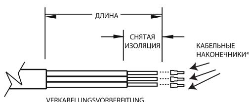
\* Компания Furman рекомендует использовать кабельные наконечники (в комплект не включены) для заделки проводов со снятой изоляцией на соединительном разъеме.
