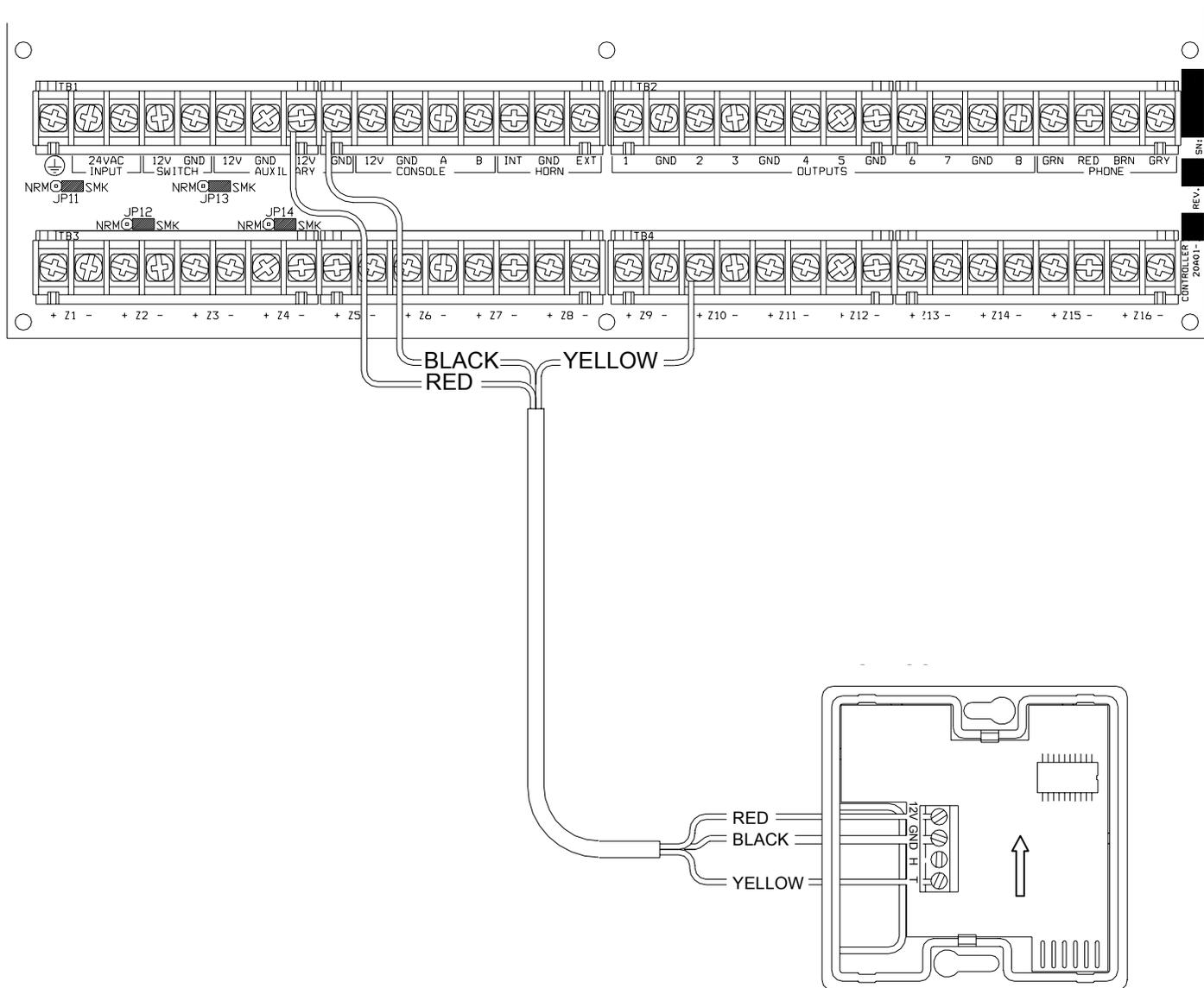
**FIGURE 1 – MODEL 31A00-7 CONNECTIONS**
